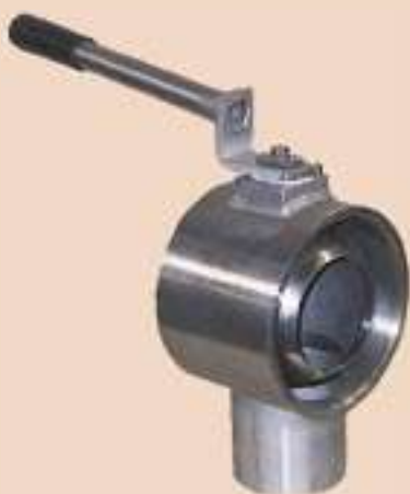
Трехходовой вентиль с просверленным отверстием на дне. Движение рычага – 180 градусов.
