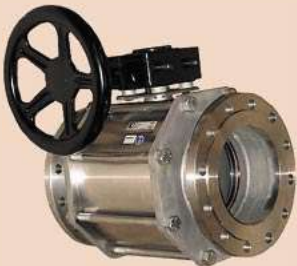
DN200 с полным отверстием, шар с твердым хромированием и металлические уплотнения. Для высоких температур и сильной абразивной среды.
