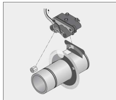
Инкрементальный оптоэлектронный принцип считывания на примере инкрементального датчика
