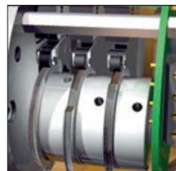
Кулачковые переключатели с конфигурируемым "шаблоном переключения"
