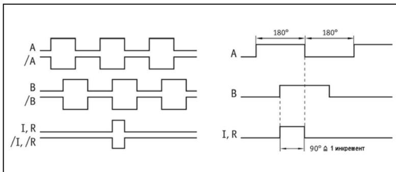
**!** Логическое состояние сигналов A и B по отношению к индексному сигналу I или опорному сигналу R не определено и может отличаться от рисунка.
