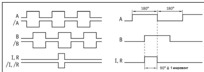
**!** Логическое состояние сигналов A и B по отношению к индексному сигналу I или опорному сигналу R не определено и может отличаться от рисунка.
