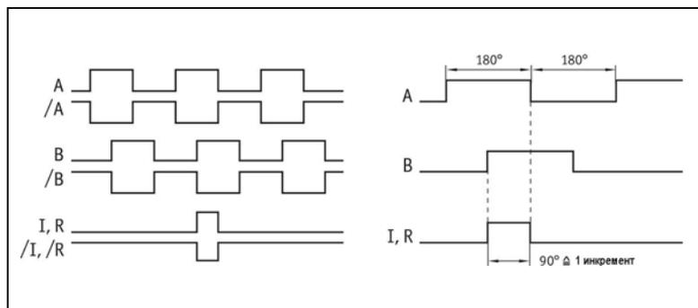
**!** Логическое состояние сигналов A и B по отношению к индексному сигналу I или опорному сигналу R не определено и может отличаться от рисунка.
