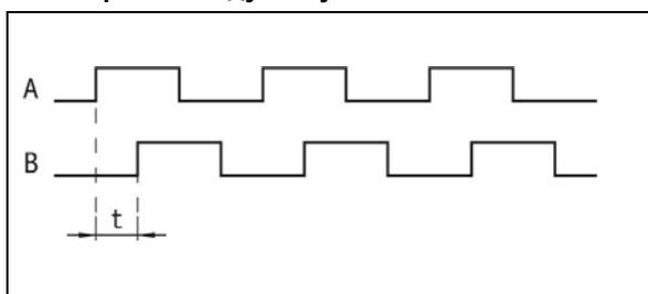
**Пример: интервал между импульсами = 1 мкс**
