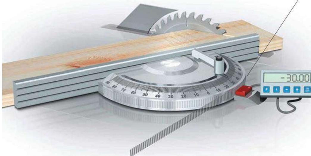
Магнитная лента служит линейкой измерительной системы. Для простого измерения углов гибкую ленту можно смонтировать дугообразно с малым радиусом изгиба
