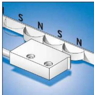
Датчик считывает магнитно-кодированную информацию о перемещении и преобразует ее в стандартные интерфейсные сигналы для дальнейшей обработки.
